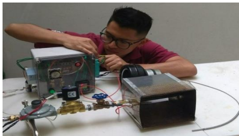
Foto 1. Alumno Investigador armando el Prototipo de quemador de gas tipo vena de aire semiautomático
